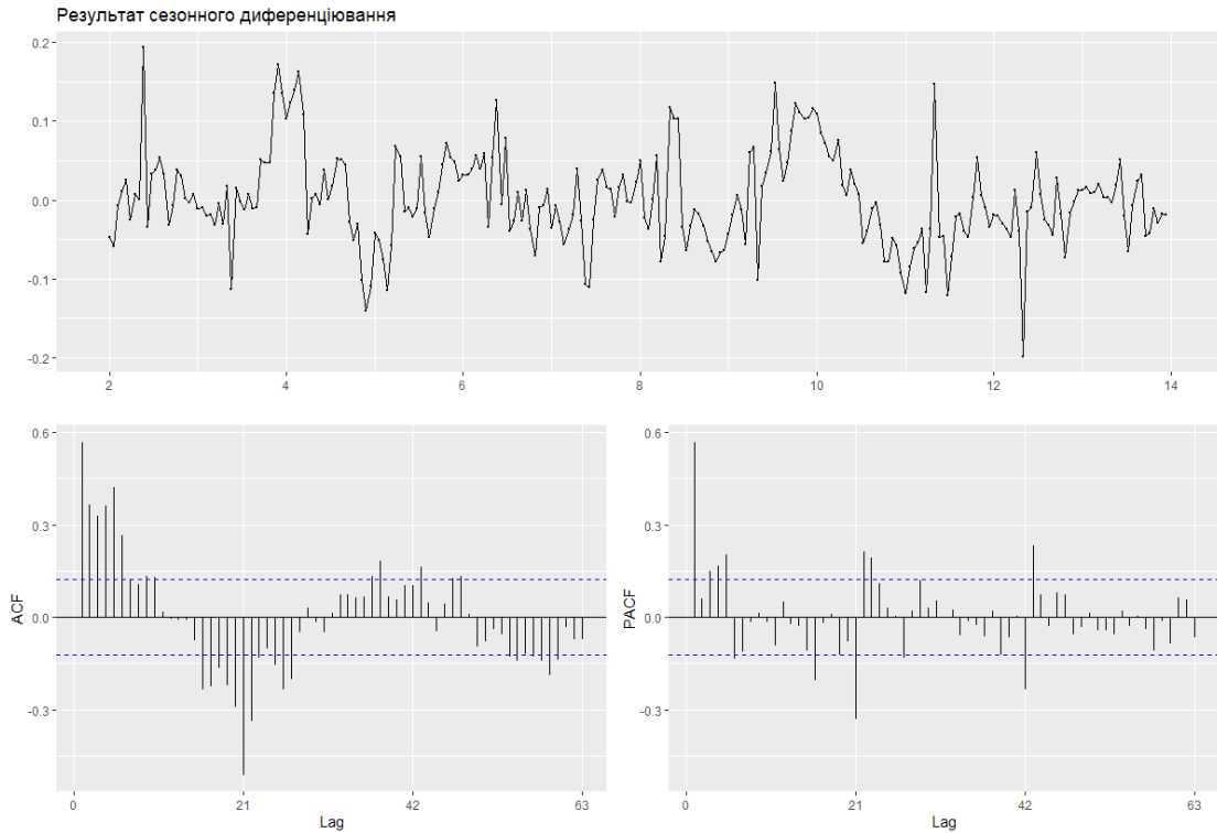
Рис.4.7. Результат сезонного диференціювання вихідного ряду
